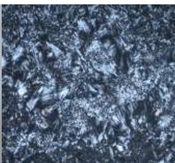
Figura 11: Fotomicrografia da amostra 06: nicóis cruzados, aumento 50X, megacalcidônia fibrosa radial em matriz de microquartzo e opala-A (?).
