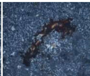
Figura 12: Estudo petrográfico (lâmina - amostra 10): grãos microcristalinos de quartzo e calcidônia, na parte central próximo, e grãos menores dominando a parte superior (Fotos: Figueiredo Filho).
