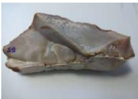
Figura 10: Amostra 19. Descrição: dureza 5 << D << 7, dureza R4, cor cinza claro amarelado (10YR 6/6), traço cinza azulado claro (GLEY 2 7/5PB), brilho fosco, fratura conchoidal, textura sacaroidal, apresenta fina cobertura de alteração de cor branca.
